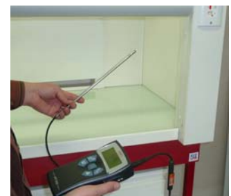
Contrôles des vitesses d'air frontales
